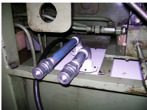
Figuras 11/12 - Uso de engates rápidos em pontos de enchimento e drenagem
