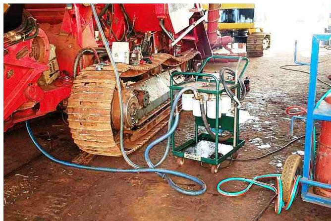
Figuras 5/6 - Filtração tipo "kidney-loop" e através de carro de filtração
