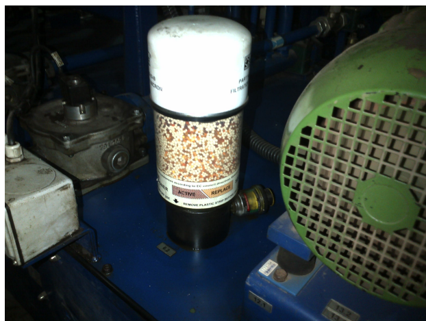
Figuras 7/8 - Respiradouros: sem proteção adequada e com filtro dessecante e de material particulado sólido
