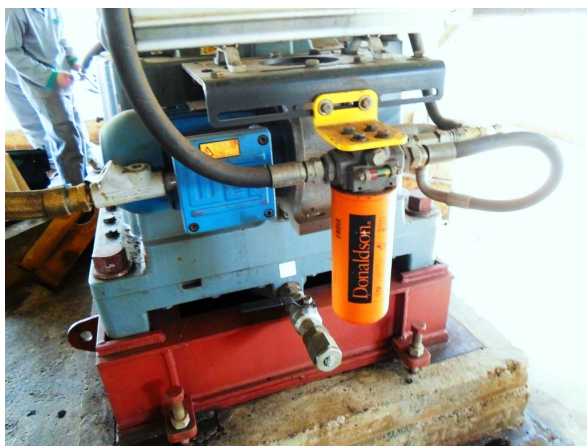
Figuras 5/6 - Filtração tipo "kidney-loop" e através de carro de filtração
