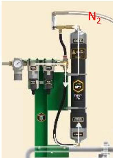
Inserir continuamente nitrogênio ( $N_2$ ) no cárter do redutor fará com que a umidade seja arrastada para o exterior pelo respiro, não reduzirá a pressão em seu interior e não permitirá o ingresso de contaminantes!
