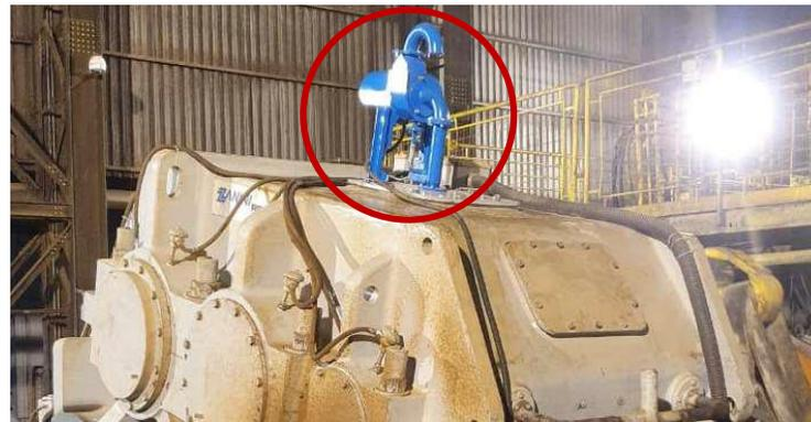
Desumidificador por exaustão, eficiente para remover a umidade, **que não deveria existir**, porém, reduz a pressão no interior do cárter e favorece o ingresso de contaminantes pelos retentores e gaxetas de eixos.
