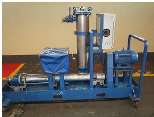
P-CTV: equipamento combinado Centrifuga e Termo Vácuo, vazões de 4, 6 e 9m 3 /h
