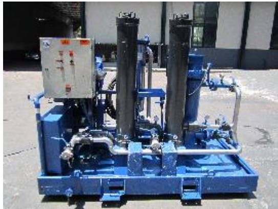
P-EFO: Unidades de “Extra Filtragem”, vazões de até 10m 3 /h Filtros \beta_{10}=200 , \beta_5=400 e \beta_2=300
