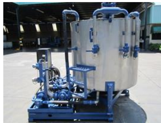
P-TVO: Termo vácuo. Vazões de até 1,5, 2,1 e 3,0m 3 /h
