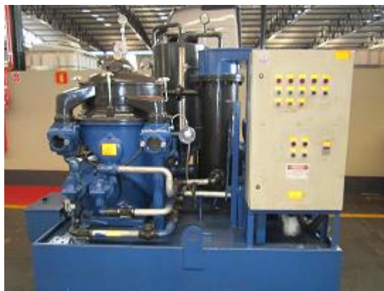
P-TOO: bomba de transferência, com ou sem controle de vazão. Vazões de até 10m 3 /h
