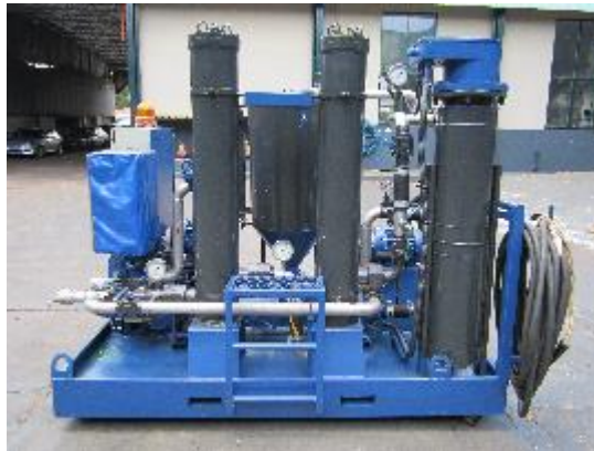
P-EFO: Unidades de “Extra Filtragem”, vazões de até 10m 3 /h Filtros \beta_{10}=200 , \beta_5=400 e \beta_2=300
