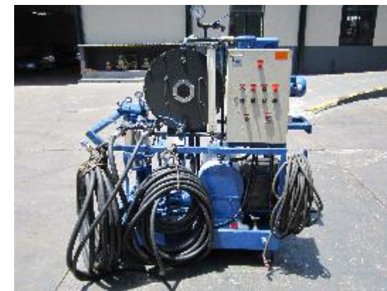
P-FOO: equipamento para flushing de tubulações industriais Vazões de até 90m 3 /h
